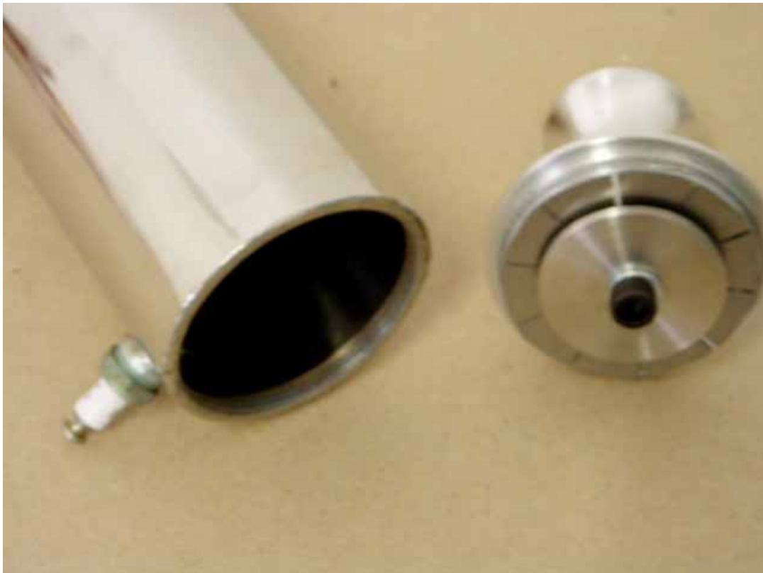
Detalhe do difusor desencaixado da câmara de combustão
