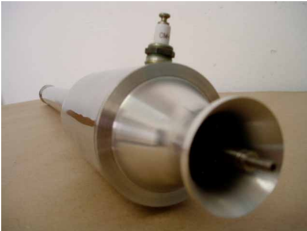
Detalhe frontal do difusor, injetor de combustível e vela de ignição.
