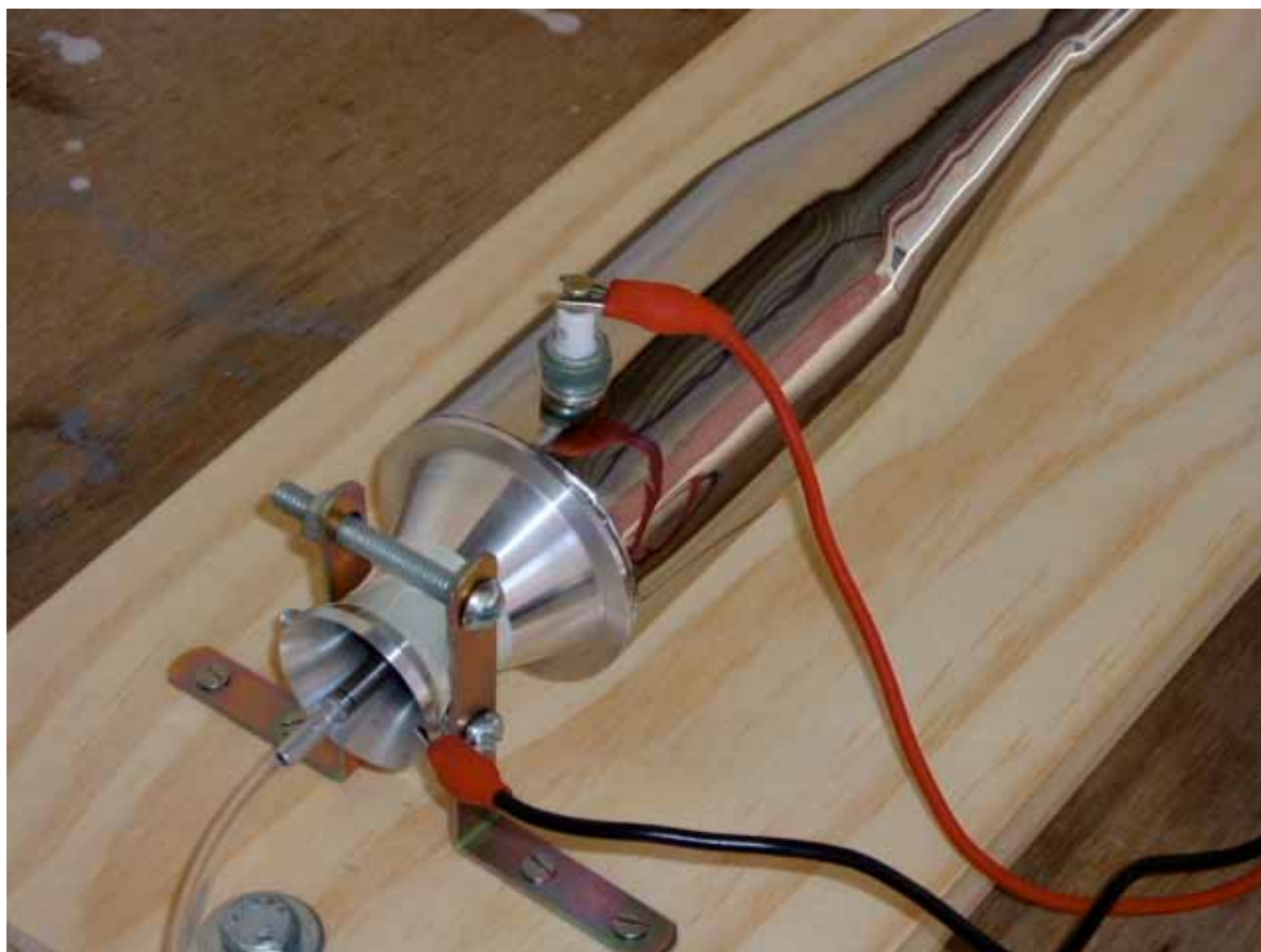
Motor fixo em bancada para teste de ignição, notar a conexão dos fios de ignição (vermelho e preto)
