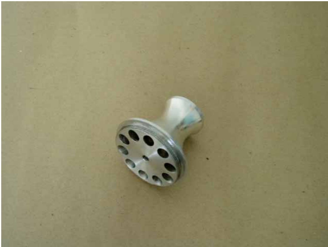
Difusor é uma peça única usinada em CNC em alumínio
