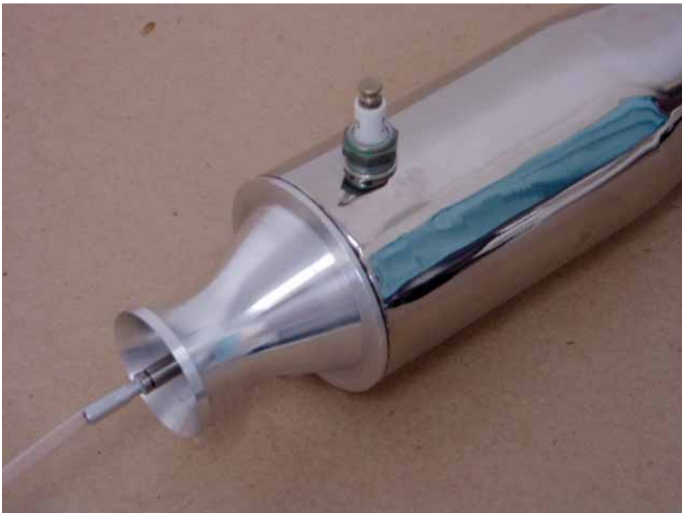
Mangueira de combustível conectada ao injetor
